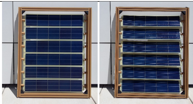
Bild 1: unter industrieähnlichen Bedingungen laminierte Solarlamellen (Monokristalline Zellen, Kapselungsmaterial EVA, Trägersubstrat Glasfaserhartgewebe) im Bild links „geschlossen“, im Bild rechts „sich öffnend“
