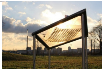
Bild 1: Ethylen-Tetrafluorethylen-Hochleistungs-Copolymerfolie (ETFE) in Überdruck-Doppelmembran – Bauweise mit integrierten Si-Photovoltaik-Modulen. Technology Readiness Level 4 von 10.
